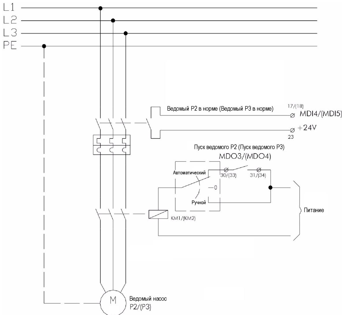
Рис. 4: Силовое подключение ведомых насосов P2 и P3
