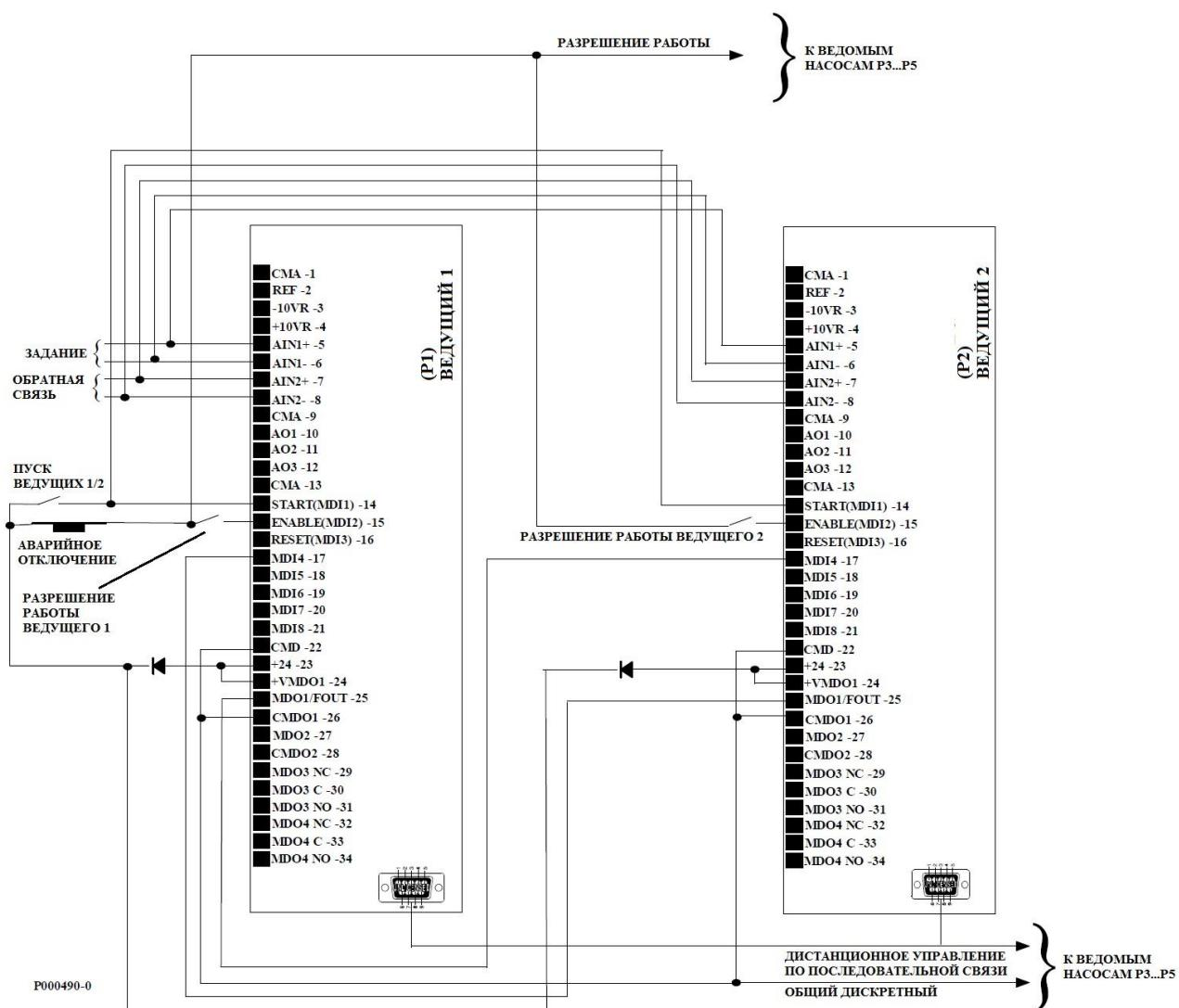
Рис. 12: Схема подключения при двух ведущих приводах.
