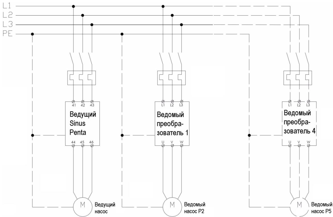
Рис. 8: Силовое подключение преобразователей, управляющих насосами станции.
