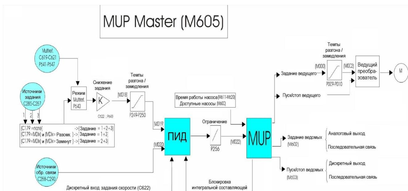
Рис. 2: Блок-схема Penta, работающего в режиме ведущего в насосной станции.
