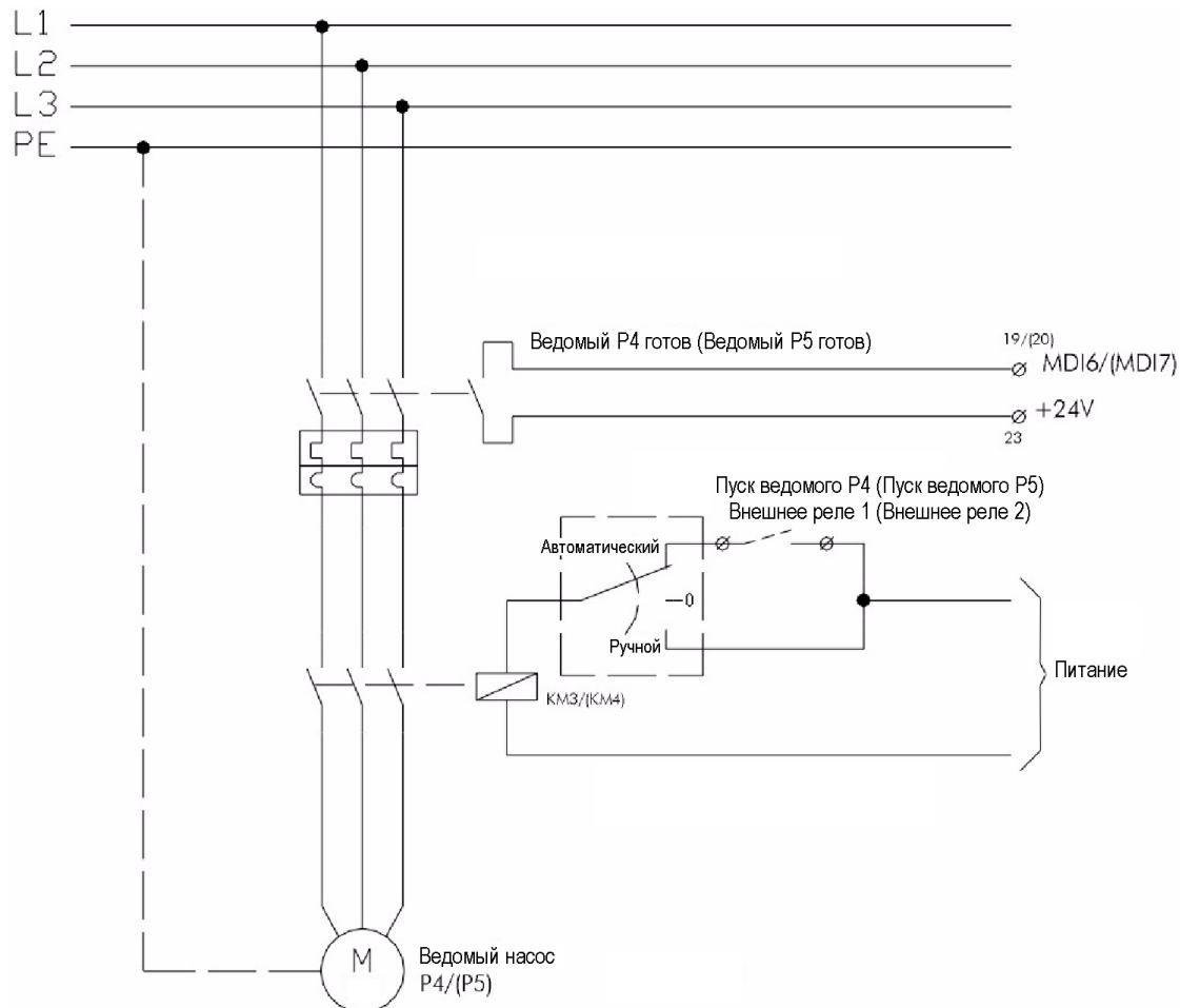
**Рис. 5: Силовое подключение ведомых насосов P4 и P5**
