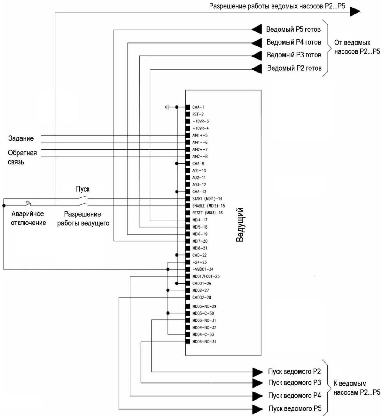
Рис. 7: Подключение сигналов задания и обратной связи, сигналов управления и т.д. к ведущему преобразователю при использовании ведомых насосов с постоянной скоростью и питании выходов MDO1 и MDO2 от внутреннего источника питания +24В.
